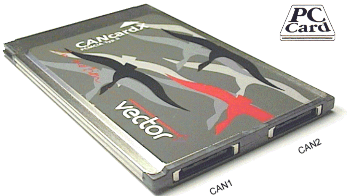
Abbildung 1: CANcardX mit I/O-Anschlüssen (CAN1, CAN2)
