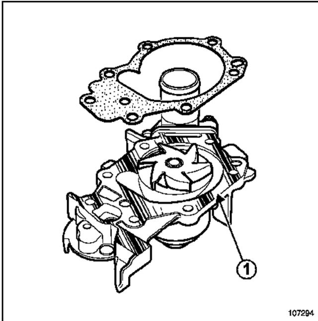
Einen Dichtungsring anbringen, wenn die Dichtfläche der Wasserpumpe eben ist (1).
