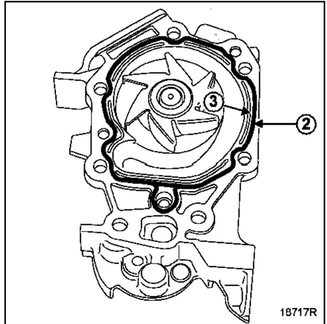
Eine Dichtraupe (2) aus **RHODORSEAL 5661** mit einer Breite von **1,3 mm** gemäß der Zeichnung auftragen, wenn die Dichtfläche der Wasserpumpe über eine Nut (3) verfügt.
