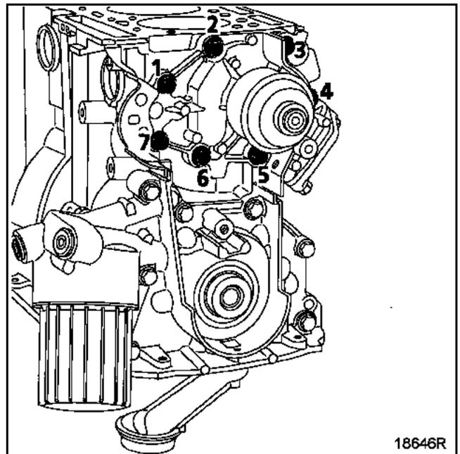
In der vorgeschriebenen Reihenfolge und mit dem vorgeschriebenen Drehmoment die **Befestigungsschrauben der Wasserpumpe anziehen (0,9 daNm)**.
