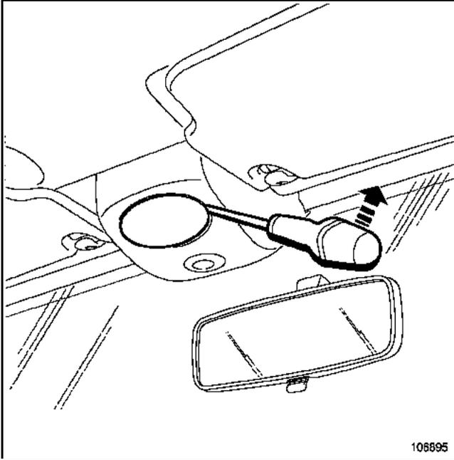
Das Lampenglas mittels Schlitzschraubendreher rechts aus der Halterung lösen.
