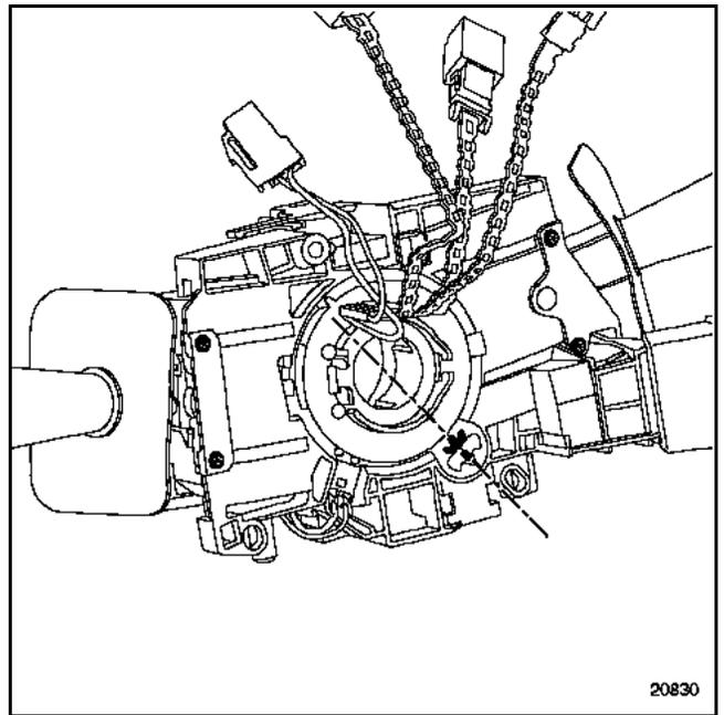
Die Befestigungsschraube der Spiralverbindung entfernen.
