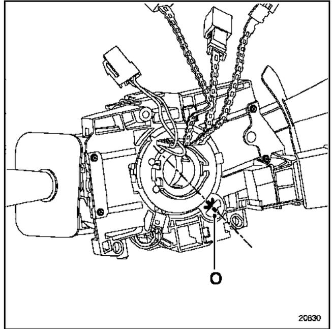
Sicherstellen, dass die Spiralverbindung korrekt angebracht ist. Sicherstellen, dass die Markierung "0" mit der Mitte der Lenksäule ausgerichtet ist.
