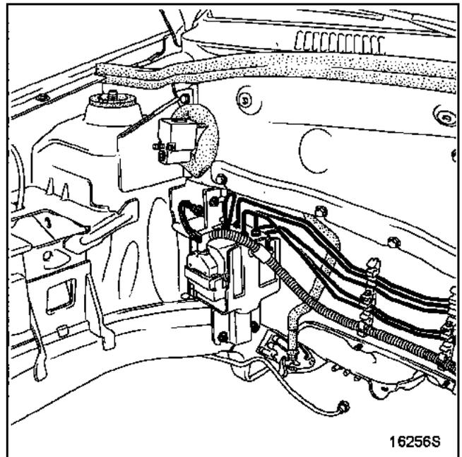
Das Hydraulikaggregat von unten her vollständig ausbauen; dieses hierzu zum Hauptbremszylinder schieben.
