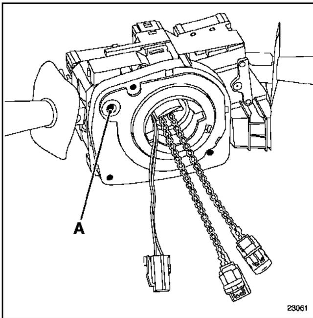
**ACHTUNG:** Bei einem **Austausch** des Lenkwinkelgebers verbindet ein Spannstift die zwei Teile des neuen Gebers!
