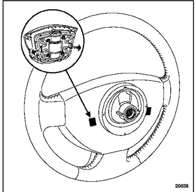
Die zwei Versorgungsstecker der Airbag-Generatoren abziehen.
