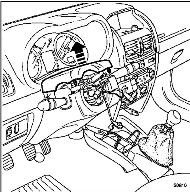
Auf die Klammer (B) drücken. Den Bediensatelliten des Radiogeräts mit Hilfe eines Schlitzschraubendrehers entfernen.
