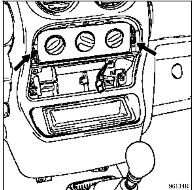
Die Bedieneinheit lösen und den Stecker abziehen.
