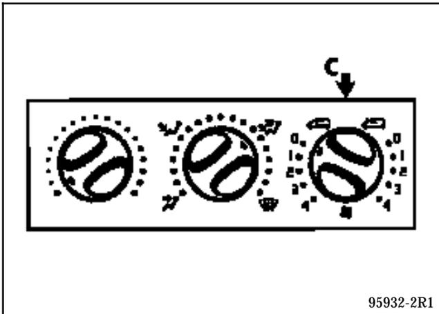
Die Belüftung erfolgt mittels Gebläseluft. Die Luftmenge, die im Fahrgastraum zirkuliert, wird über den Regler (C) bestimmt. Es gibt zwei Möglichkeiten von Luftansaugung: Außenluft oder Umwälzluft.
